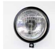
Scheinwerfer für Steyr T 80, Schraubanschluss M12, 105 mm Durchmesser
